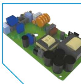
Драйвер собственной разработки, который обеспечивает защиту светильника от перегрева короткого замыкания и МКС-помех
