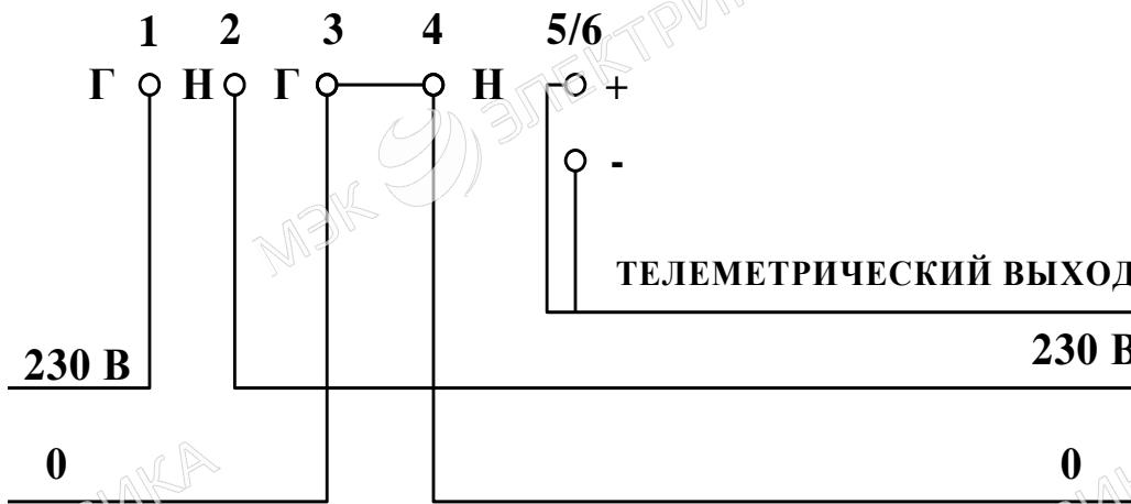
Примечание - Номинальное напряжение, подаваемое на телеметрический выход, равно 12 В (предельное - 24 В).
